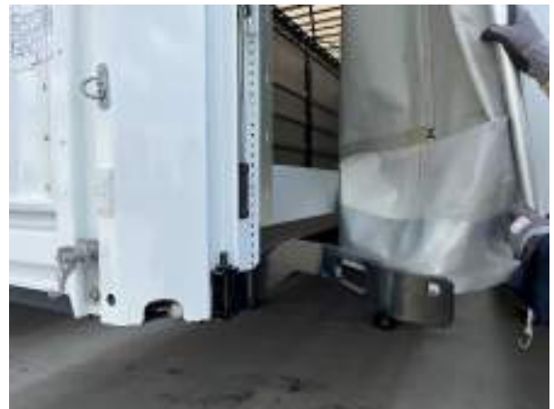
Зняття шторної труби
