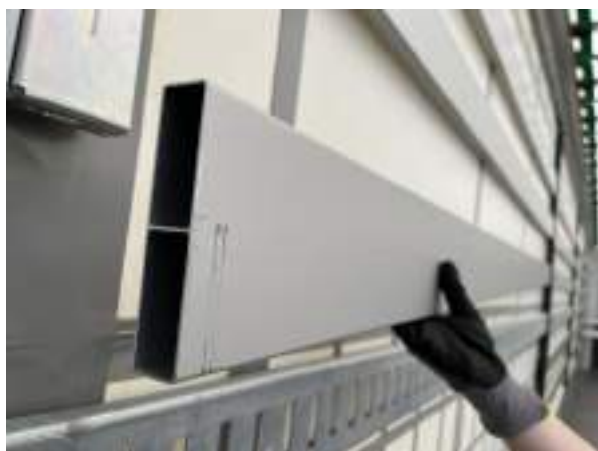
Алюмінієвий бічний ряд коробчастого профілю
