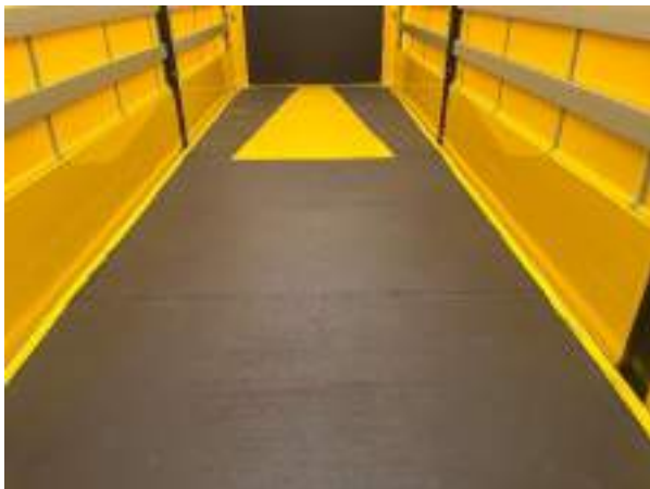
Фанера, покрита феноловою смолою
